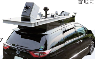
移動式高精度三次元計測システム 「モバイルマッピングシステム(MMS)」
