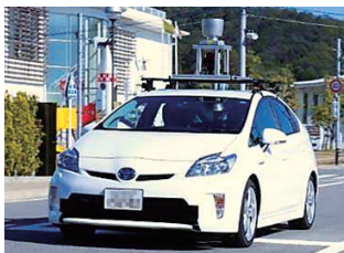
名古屋大学が開発した自動運転車両 当社作成の高精度三次元地図を実装しています。
