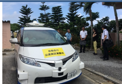
本試乗会において当社所有の自動運転車両を提供し、事前に作製した高精度3次元地図とレーダーにより周囲を検知しながら走行を行いました。
