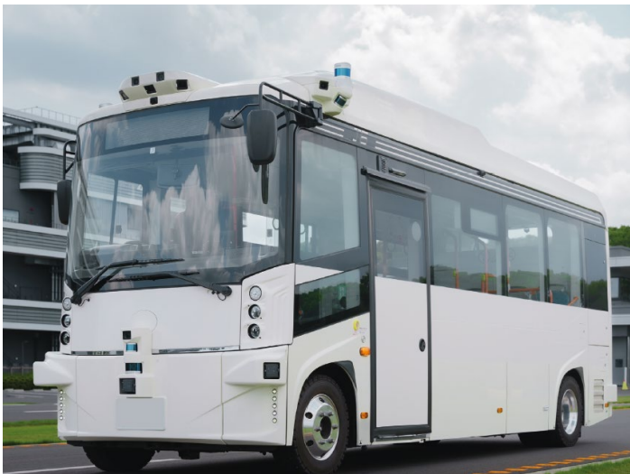
■ティアフォー製自動運転小型 EV バス「ティアフォー-Minibus」
