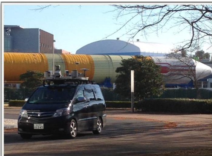
MMSによる計測 (筑波宇宙センター)
